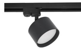
53006-9.3-001LD GX53 BK алюминий D=83mm h=140mm цоколь лампы: GX53
